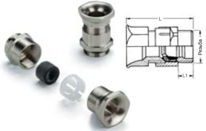
Кабельный ввод с защитой кабеля от перегиба и встроенным зажимом кабеля. Без хомутика для кабеля. Зажим из пластика Hostaform C.
