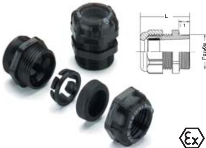
Кабельные вводы для применения во взрывоопасных средах (EEx e II), соответствуют DIN-EN 50014 и DIN-EN 50019 (L.C.I.E. 93 C 6110X). В кабельном вводе встроена дополнительная защита кабеля от выдергивания. Уплотнитель поставляется с легко удаляемой мембраной, служащей для защиты от пыли и в качестве дополнительного уплотнения. Поставляются в варианте с метрической резьбой ISO.
