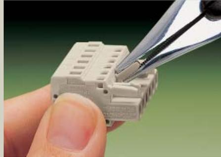
Кодировка розетки – выламывание кодировочных штифтов
