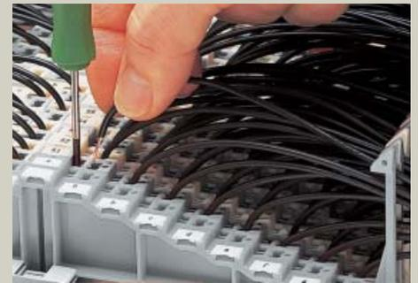
Подсоединение проводов при помощи отвертки с лезвием 2.5 x 0.4 мм
