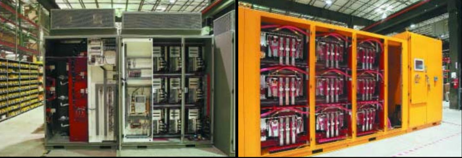
Подчеркивая гибкость возможностей, присущих приводу Perfect Harmony следует отметить, что возможна установка с принудительным воздушным охлаждением - (крайний слева) либо с внутренним замкнутым водяным охлаждением (рисунок слева). В стандартную поставку при водяном охлаждении входят запасные насосы, а при воздушном – резервные нагнетатели.
