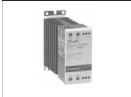
Мягкий пускатель TCI 25C предназначен для плавного запуска однофазных компрессоров. В процессе запуска TCI 25C будет постепенно поднимать напряжение двигателя до полного линейного напряжения, снижая таким образом максимальный пусковой ток.
