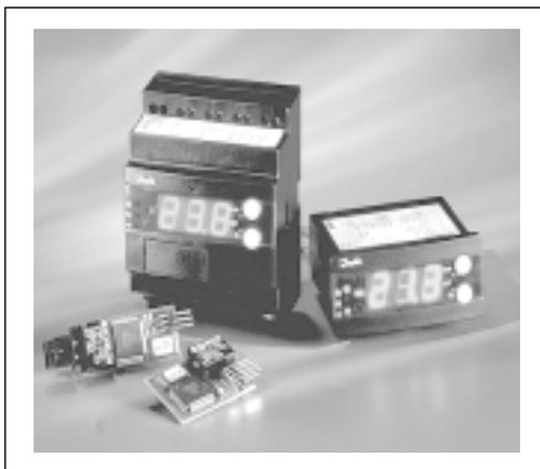
ЕКС 201 (для установки на панель) и ЕКС 301 (для монтажа на DIN - рейку) специально разработаны для управления режимами работы холодильных установок таким образом, чтобы максимально возможно оптимизировать и упростить операции установки и программирования блоков.
