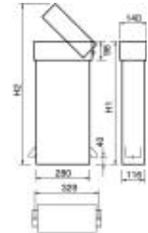
Fig. 9 Dimensiones CSM CSM Dimensions (mm) a: H1 = 420, H2 = 692 b: H1 = 645, H2 = 917 c: H1 = 795, H2 = 1067
