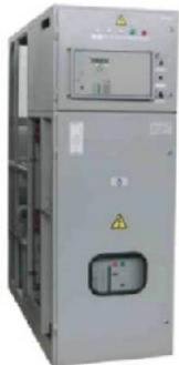
2.1. Главные и аварийные распределительные щиты для подключения генераторов мощностью от 160 до 2500 кВт, напряжением 350 до 660В, 50/60 Гц, распределение по фидерам потребителей, степень защиты IP20, IP21, климатика ОМ4.
