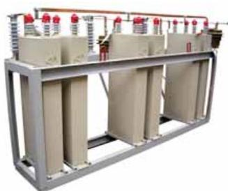
Внедрение батарей статических конденсаторов позволяет увеличить напряжение на шинах подстанций на 3-4 %, снизить потери в сетях 6 - 220 кВ. Батареи позволяют скорректировать перетоки энергии и регулировать напряжение в энергосистеме. Кроме того, при преваливании тяговой нагрузки, вследствие ее
